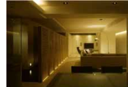
夜は人の居る所の器具のみ点灯 使用電力は 7 0 %
