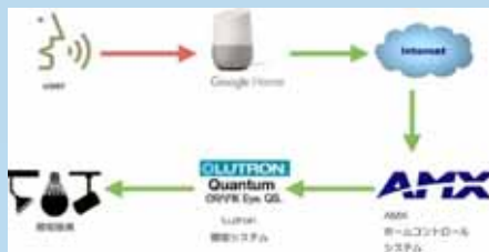
Lutron照明システムを使った家中の照明回路をコントロールする例
