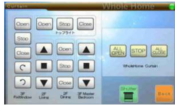
各カーテン&窓シャッターの詳細操作画面
